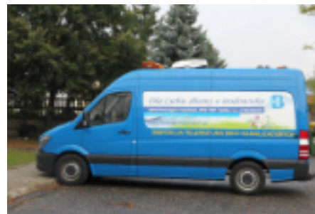
Samochód do inspekcji telewizyjnej kanałów sanitarnych i deszczowych
